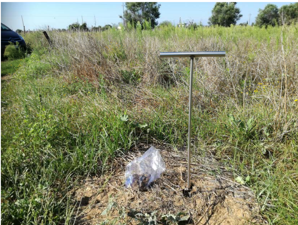
Foto 1,2 – Prelievo del campione di terreno vegetale dal sito di progetto per essere sottoposto a determinazioni analitiche di laboratorio.
