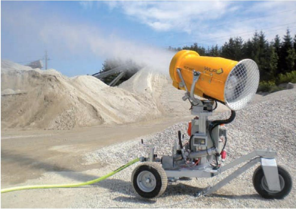
La bagnatura delle superfici di transito dei mezzi o la bagnatura delle aree sulle quali vengono effettuate le lavorazioni con conseguente movimentazione dei cumuli di materiale è necessaria sia a limitare la generazione di polvere, sia a far precipitare a terra le polveri aeree disperse che inevitabilmente si generano seppur in misura ridotta.
