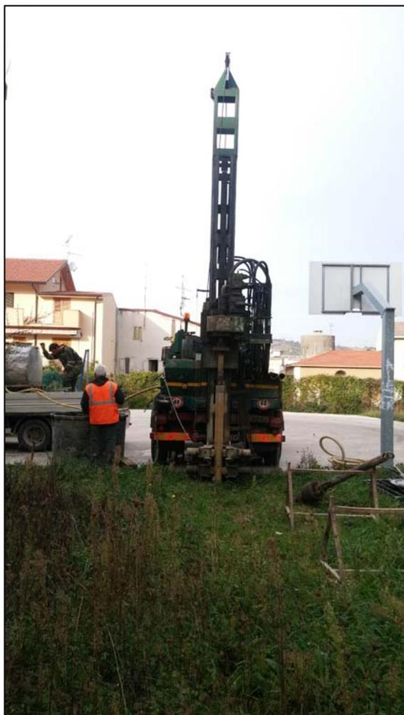
Fig.1 Impianto di perforazione CMV 600.
