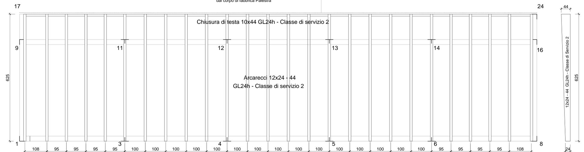
PIANTA TRAVI DI COPERTURA IN LEGNO
