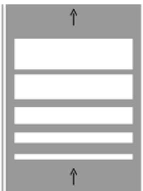
Sulla base delle indicazioni progettuali ovvero della Direzione Lavori, i sistemi di rallentamento ad **effetto acustico** saranno realizzati mediante irruvidimento della pavimentazione stradale ottenuta con la scarificazione o incisione superficiale della stessa o con l'applicazione di strati sottili di materiale in rilievo in aderenza, eventualmente integrato con dispositivi rifrangenti. Tali dispositivi possono anche determinare
